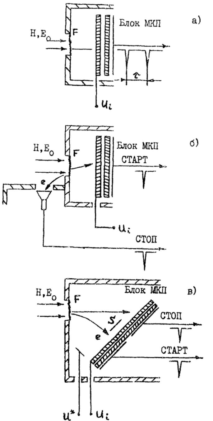
Рис.2. Разработанные макеты ВП детектора-энергоанализатора.
