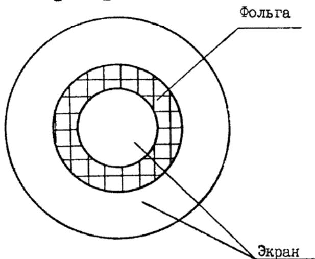
Рис.6. Входная поверхность детектора-энергоанализатора в виде кольца.
