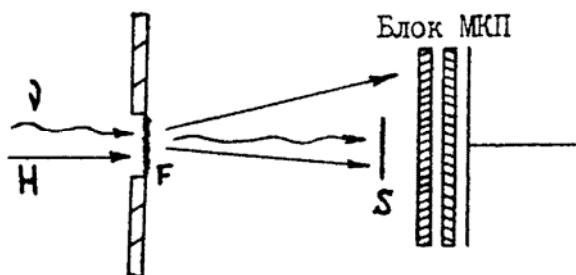
Рис.5. ВП детектор-энергоанализатор с поглощающим экраном **S**.
