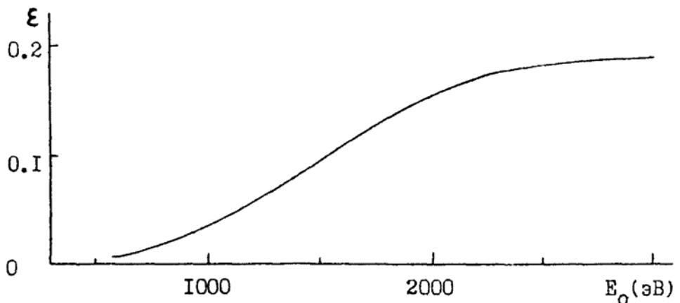
Рис.4. Зависимость эффективности регистрации  $\epsilon$  атомов Н детектором-энергоанализатором от энергии частиц  $E_0$ .
