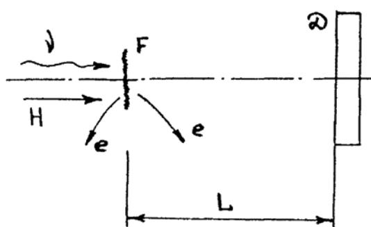
Рис. I. Детектор для регистрации частиц методом совпадений.
